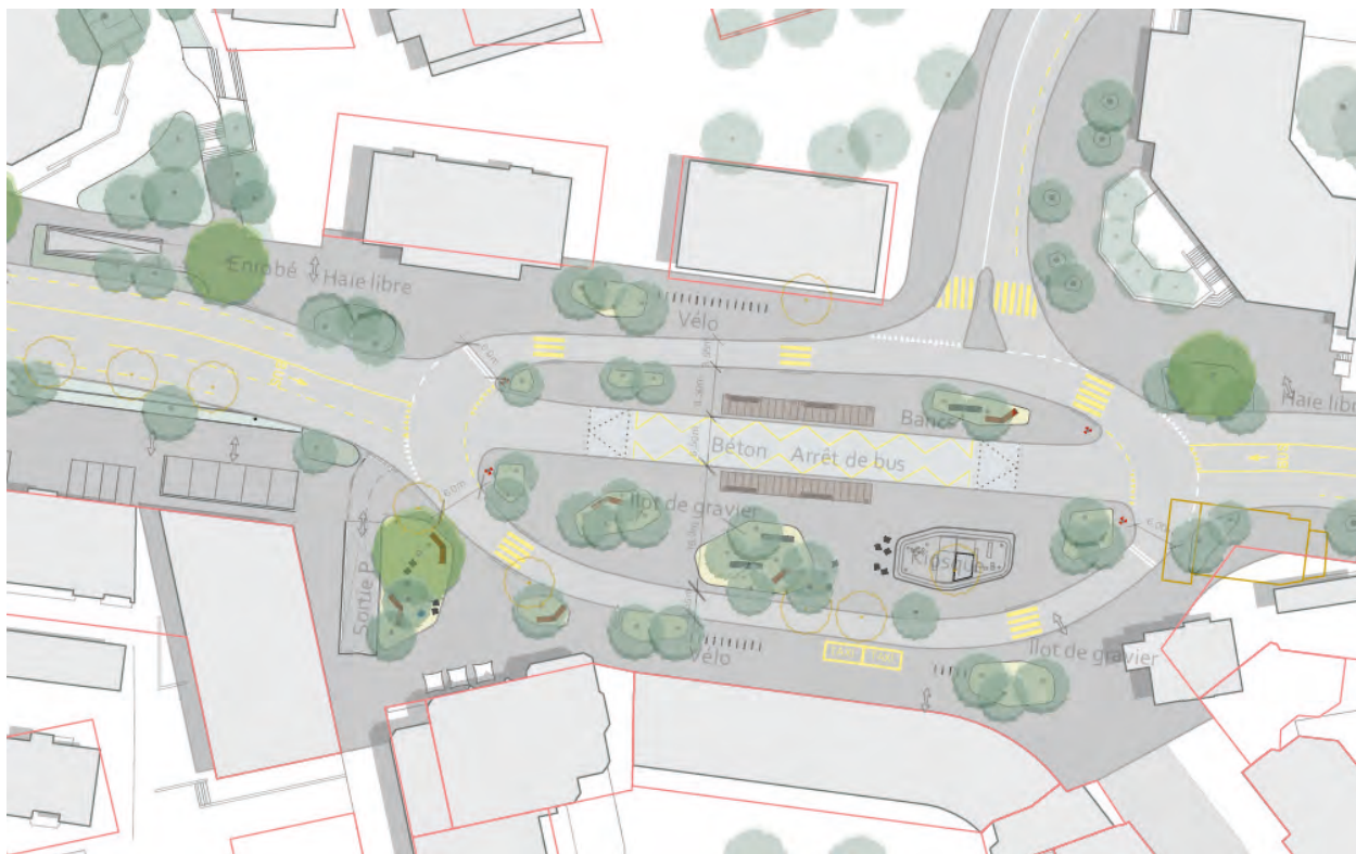
Giratoire percé d'un arrêt central pour les bus au carrefour Clergère
