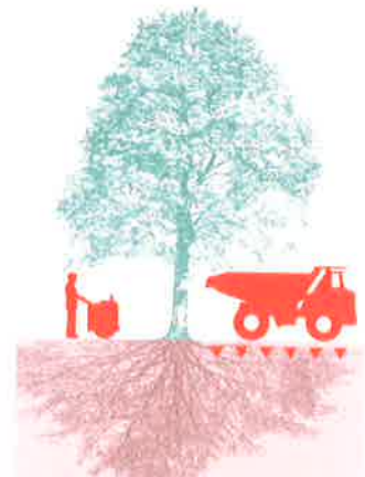
Compactage du sol
