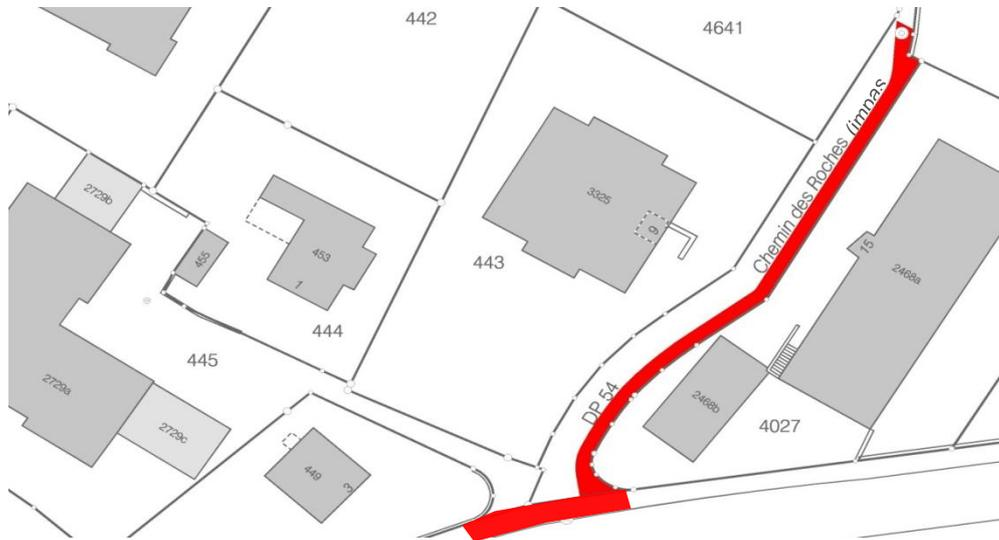
*Situation du trottoir projeté, d'une hauteur de 4 cm et d'une largeur de 1.45 m, le long de l'impasse du ch. de Roches sur 60 m ainsi que du trottoir franchissable au débouché de l'impasse*
