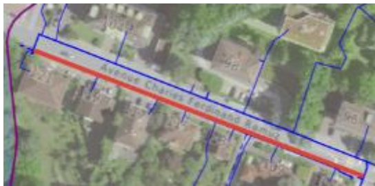
Tronçon « av. C. F. Ramuz » Conduite : fonte de 1982 Longueur à remplacer : 154 m Nombre de fuites connues à ce jour : ~ 4
