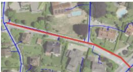
Tronçon « ch. des Marguerites » Conduite : fonte de 1971 Longueur à remplacer : 164 m Nombre de fuites connues à ce jour : ~ 2
