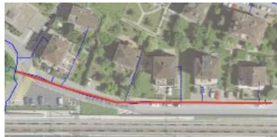
Tronçon « av. des Alpes » Conduite : fonte de 1984 Longueur : 134 m Nombre de fuites connues à ce jour : ~ 3
