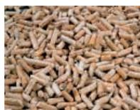
Pour la fabrication des pellets cylindriques de 5 à 45 mm de longueur, on utilise de la sciure et des copeaux provenant de l'industrie du bois, qui sont pressés à haute pression au travers d'une matrice.
