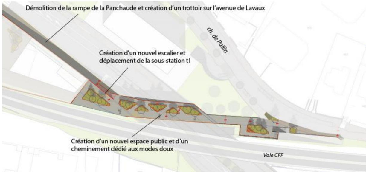
Figure 6 : Illustration du projet de requalification du pont de la Panchaude / vue en plan - @Ville de Pully
