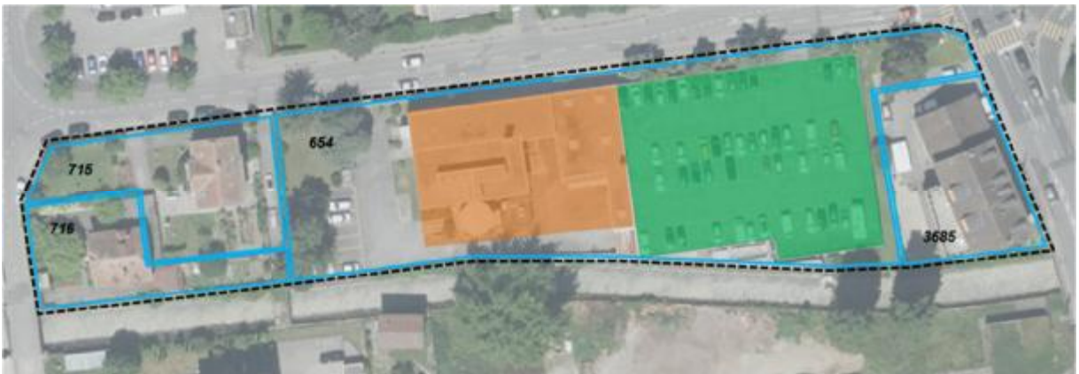
Figure 7 Vue en plan : En orange partie reconstruite à neuf, en vert partie avec réutilisation partielle du génie civil existant
