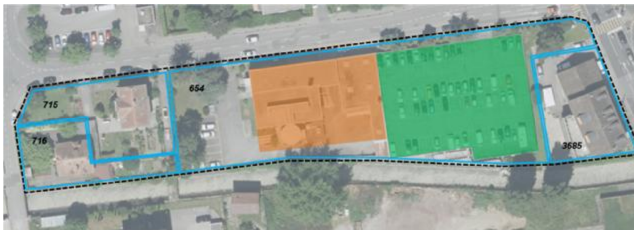
Figure 19 en orange : partie reconstruite à neuf (limite des 3m à respecter), en vert partie avec réutilisation partielle du génie civil existant
