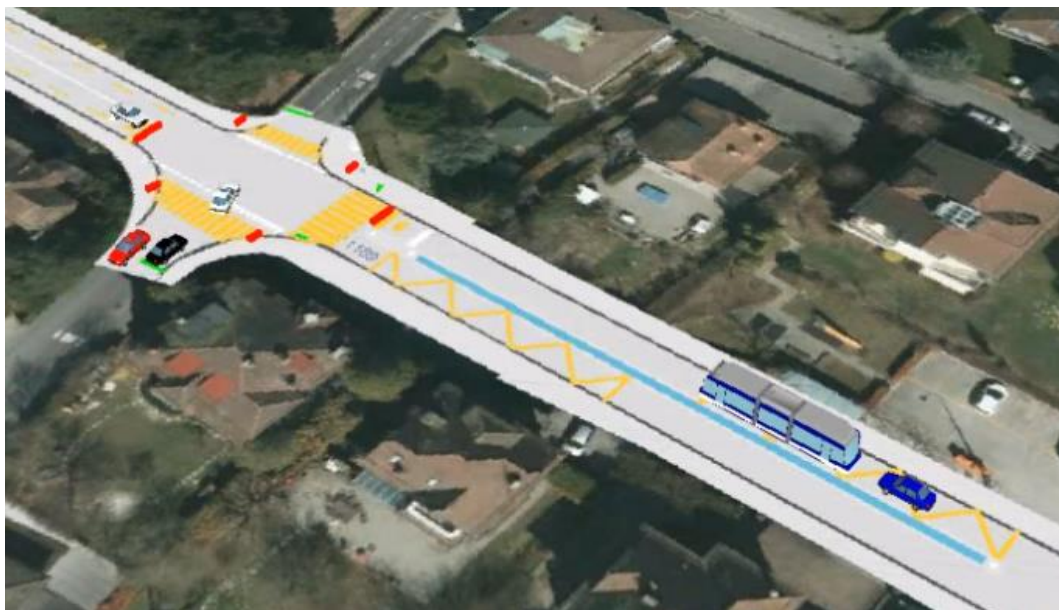
Bus et voitures à l'arrêt Rosiaz (direction Lausanne) et feu vert donné aux branches secondaires du carrefour
