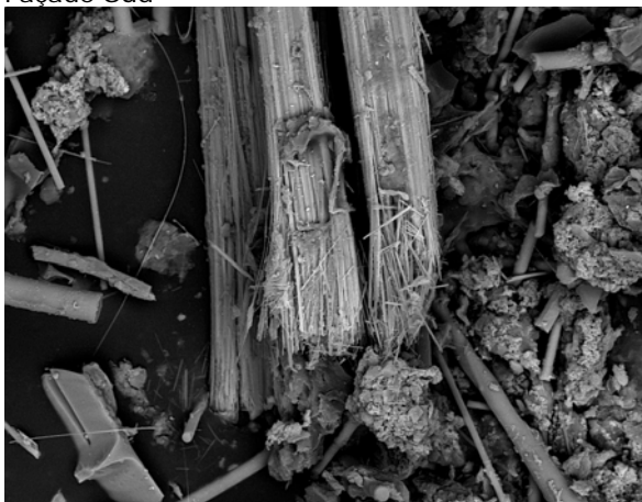
Fibres d'amiante présentes dans les faux plafonds
