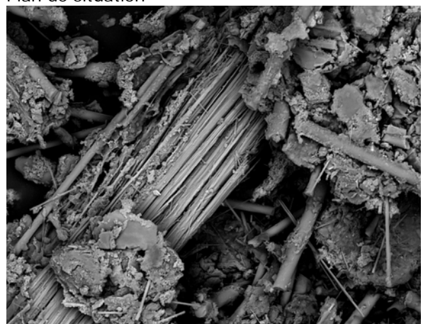
Fibres d'amiante présentes dans les faux plafonds
